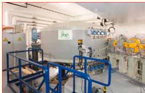
Un cyclotron de protonthérapie d'IBA.
