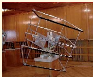
Magnétomètre Théodolite pour la mesure des caractéristiques du champ géomagnétique
